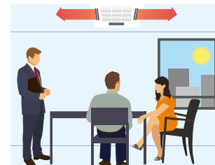
Режим прямого потока воздуха при обнаружении движения
