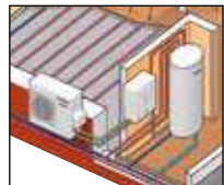
1b Вариант: двухблочная система
