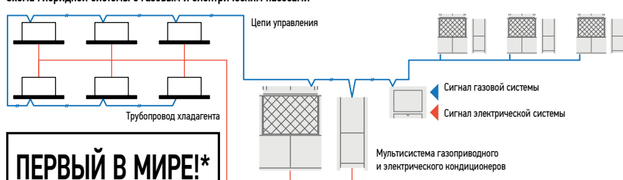
Схема гибридной системы с газовым и электрическим насосами
